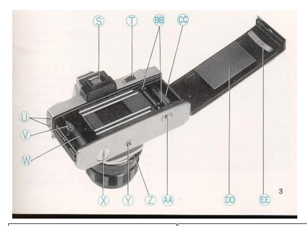
T) Average Spot SwitchAA) Rewind ButtonU) Flash Socket (2)BB) Sprocket Teeth (2)V) Rewind ShaftCC) Take-up SpoolW) Film ChamberDD) Film Pressure PlateX) Exposure Meter Battery Compartment CoverEE) Cartridge Retaining SpringY) Tripod SocketEE) Cartridge Retaining Spring
